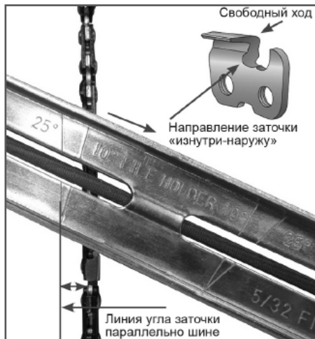
Рис. 28 Определение угла заточки
