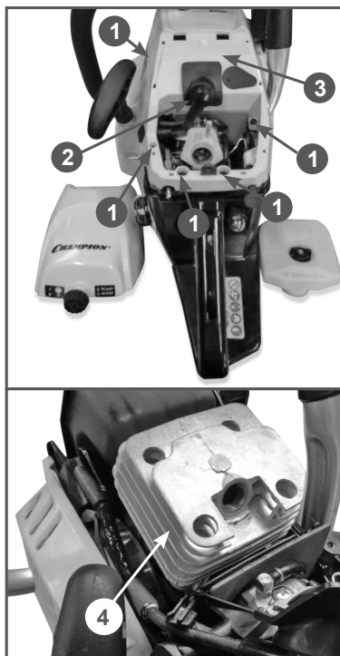
Рис. 23 Очистка охлаждающих ребер цилиндра
