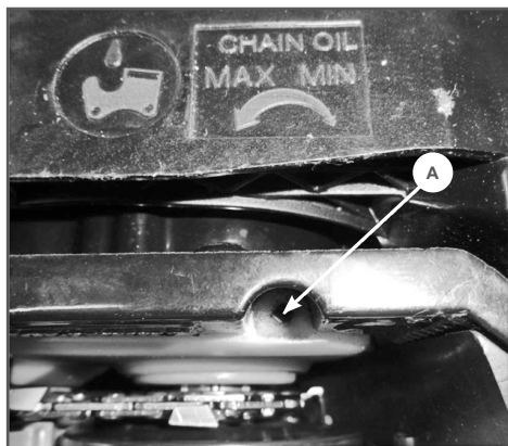
Рис. 13 Положение регулировочного винта подачи масла
