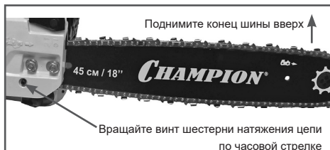
Рис. 5 Регулировка натяжения цепи
