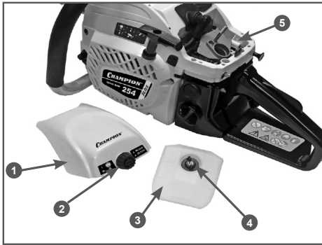
Рис. 21 Обслуживание воздушного фильтра
