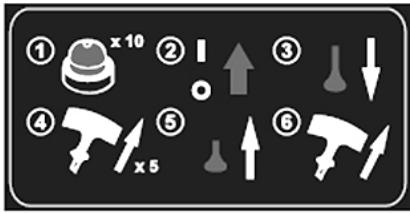
Рис. 12 Алгоритм запуска двигателя
